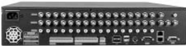
Рис. 2. Задняя панель 16-канального регистратора MDR-16800D1
